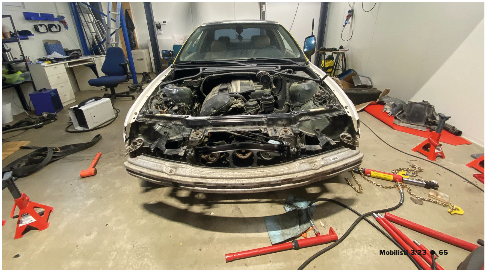
Peltien sovitus oikaisun jälkeen. E36-koriseen BMW:hen saa helposti peltiosia, sillä niitä harrastetaan paljon.
