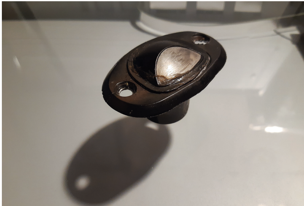
Dodge Aspenin takarekisterikilven valokotelo kohtalaisessa alkuperäiskunnossa. Tästä lähtökohdasta aloitettiin 3D-prosessi.
