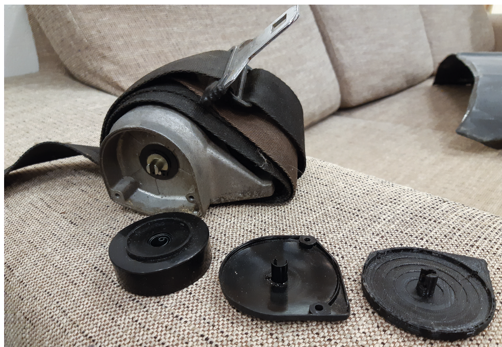
Jaguarin rullaturvavyön mekanismia, jossa on hyödynnetty kekseliäästi muovia, joka ei kilise tai kolise. Siinä on kuitenkin liian hentoja kohtia, joiden korjaamiseen on enää vähän muita keinoja kuin 3D-tulostaminen.
