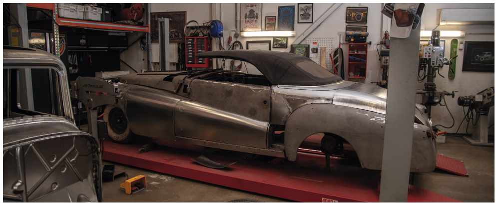
Aihio oli kuulemma jo ennestään pilattu, joten rikos ei ole suuri. 1946-48 Lincoln Continental muuttua muotoaan Lumon peltiartesaanien käsissä. Konseptiauto kantaa nimeä "Illusion". Voimalinja V12-Jaguarista on jo paikallaan taka-akseleineen. Avokatto on suoraan 2000-luvun Audi A4:stä!
