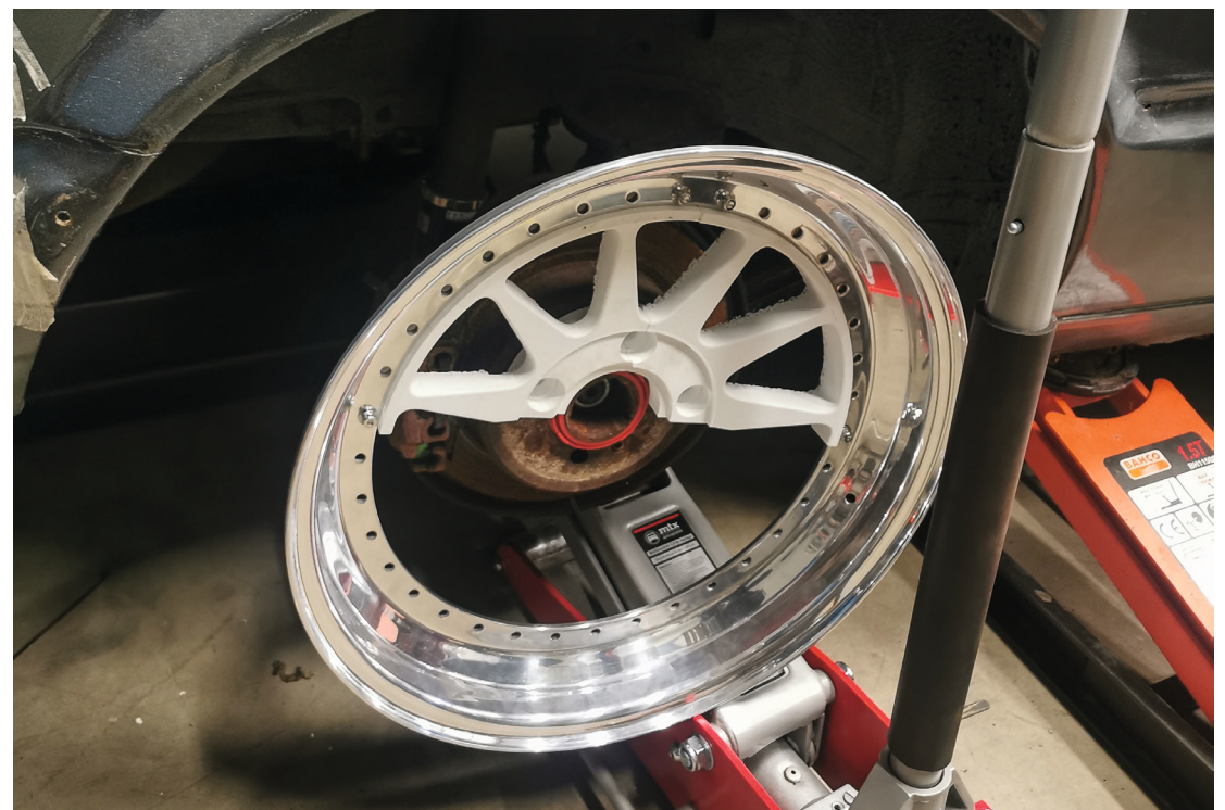
3D-mallin pohjalta voitiin tehdä simuloitua kuormitustestit SolidWorks Simulationilla. Valmis keskiö koneistetaan alumiinista. Pölykapseli voidaan tulostaa. Lipat ja kannun saa ostettua valmiina kaupasta.
