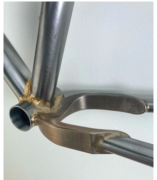
Jouni Jalkanen on hyödyntänyt 3D-tulostettuja komponentteja polkupyörän rungon valmistamisessa. Takahaarukan alaputken osa on suurella rasituksella, mutta senkin voi valmistaa tulostamalla.
